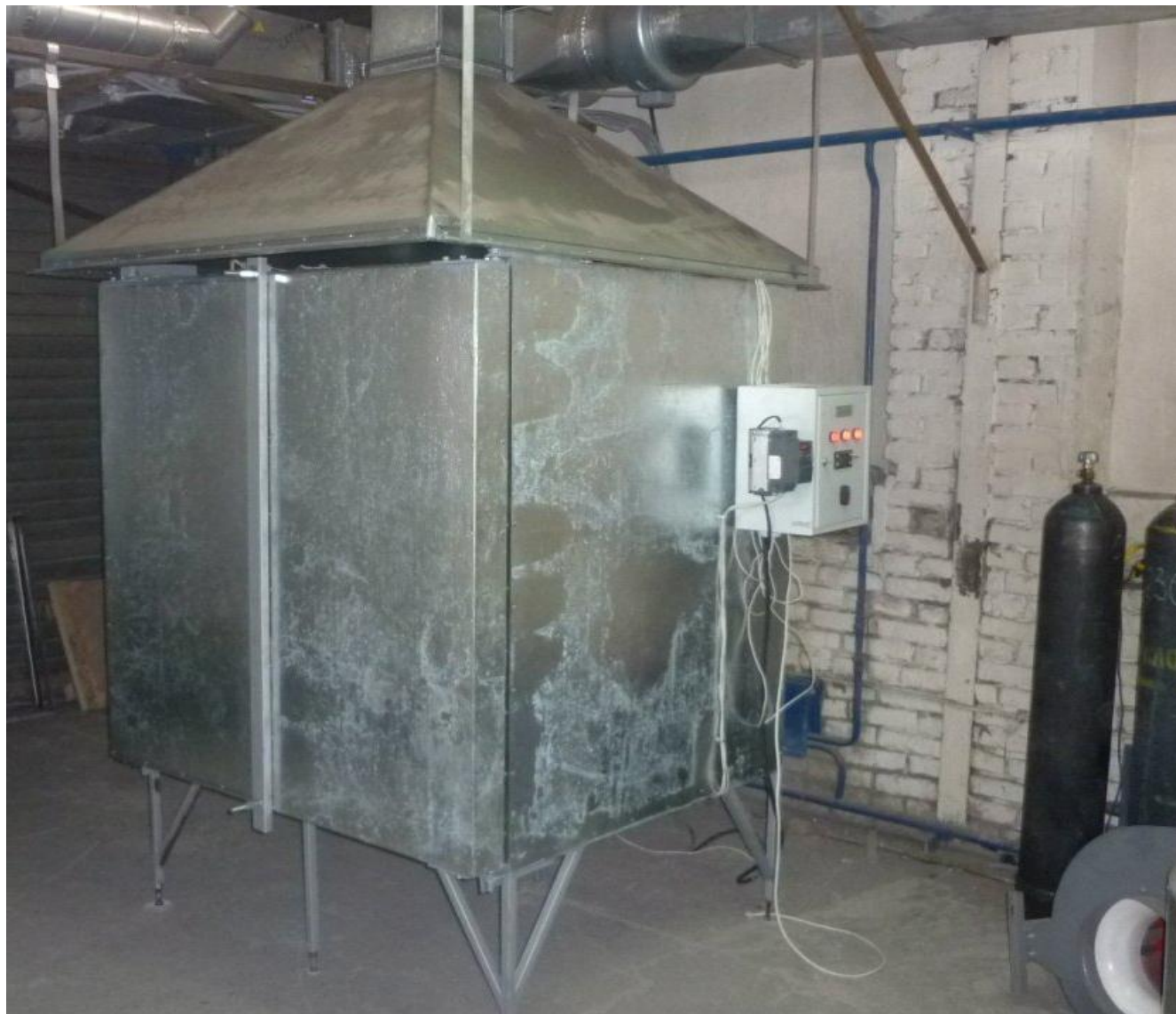
Сушка и низкотемпературная активация гранул
